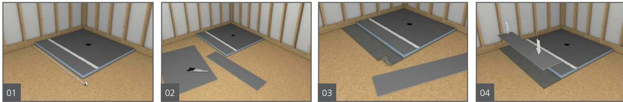
1. Determine las mediciones para la siguiente área de ducha extendida. En este ejemplo, estamos extendiendo el área de ducha únicamente en una sola dirección con nuestros paneles de extensión para la conexión con un panel de extensión previamente instalado. De esta forma, las bases de ducha Fundo wedi pueden extenderse de forma indefinida. Tenga en cuenta que todas las extensiones añadidas aumentarán la altura de la construcción desde el piso hasta la pendiente incorporada en las extensiones.
